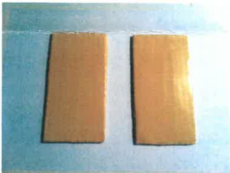
Plaquettes résine époxy contaminée + solution stratifiée OENOPERL P45
